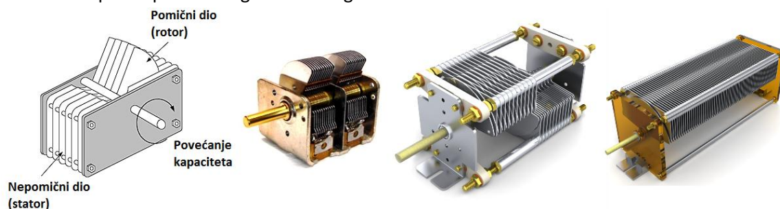
Slika 4.3.2 – 1 Primjer konstrukcije i izvedbe zakretnog kondenzatora
