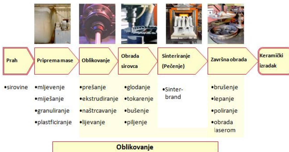
Slika 6.4.5 – 1 Bitne faze procesa proizvodnje keramike
