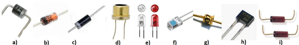
Slika 5.8.1 – 4 Prikazi poluvodičkih dioda: a) signalana; b) Zener; c) Schottky; d) Shockley; e) LED; f) Photo-; g) Tunelska; h) Varikap; i) PIN
