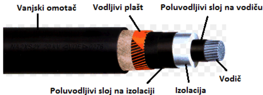
Slika 3.1.3 – 1 Presjek jednožilnog kabela
