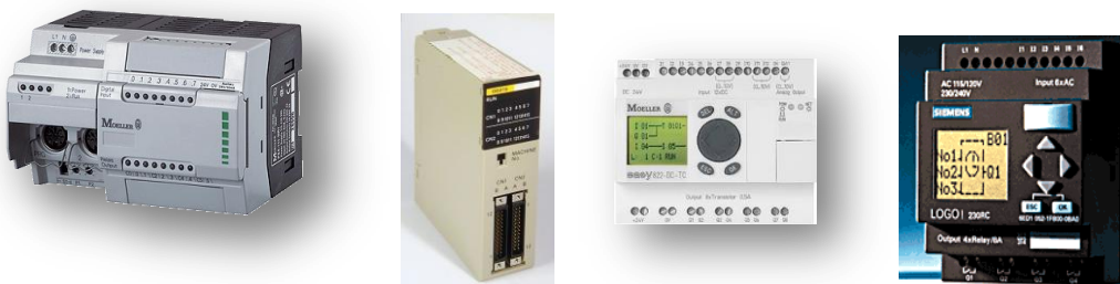
Slika 2. PLC raznih proizvođača – 4. po redu je PLC LOGO Siemens
